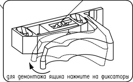
для демонтажа ящика нажмите на фиксаторы
